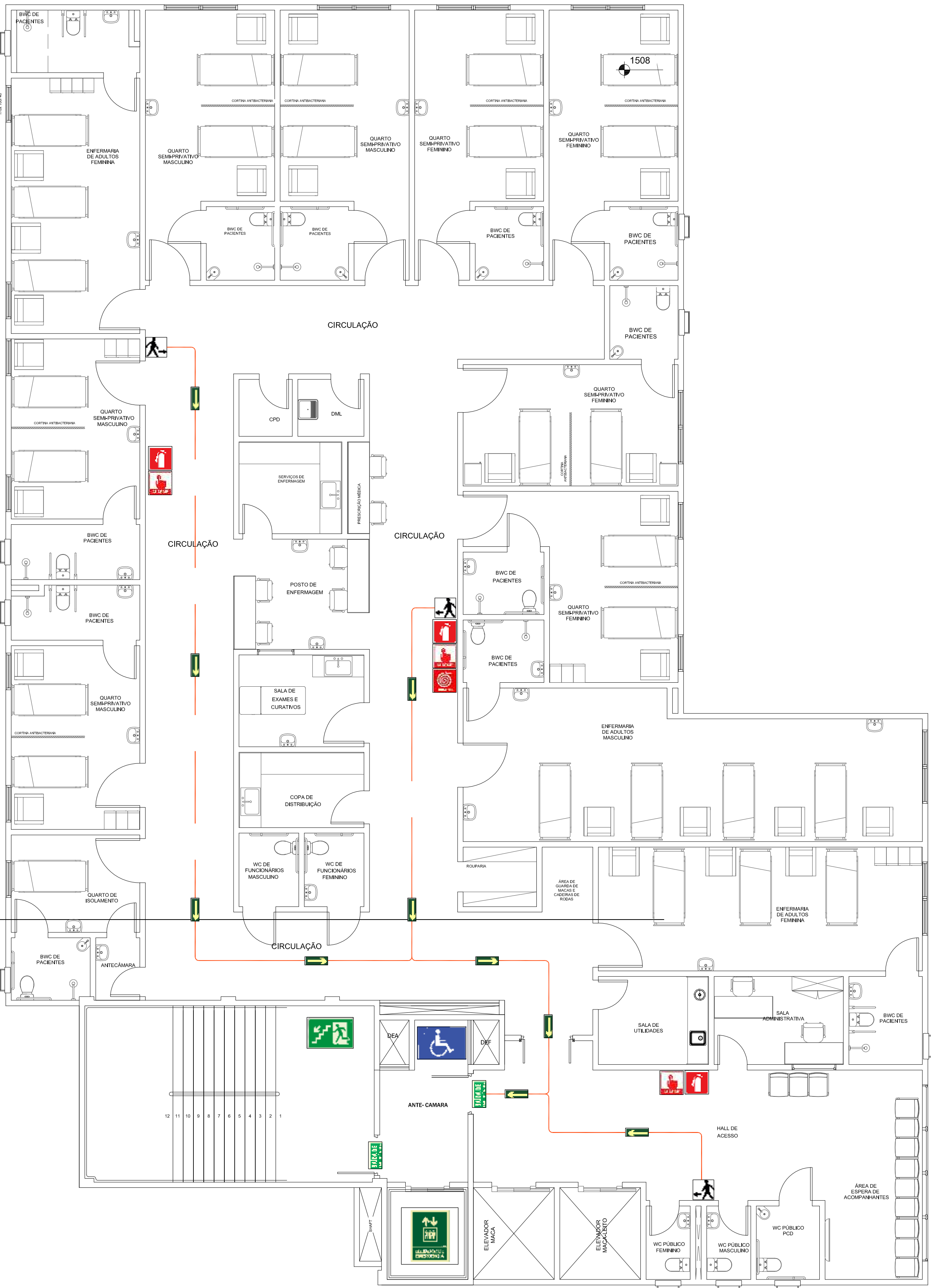
PLANTA DE EMERGENCIA 5º PAVIMENTO
